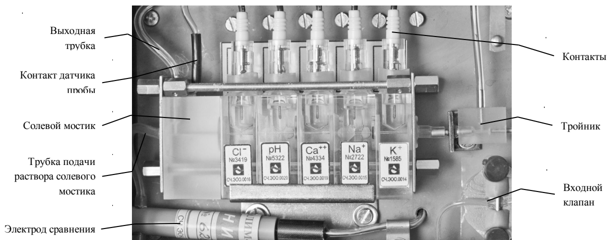
Рисунок 5а - Электродный бокс с пластиковым электродом сравнения
