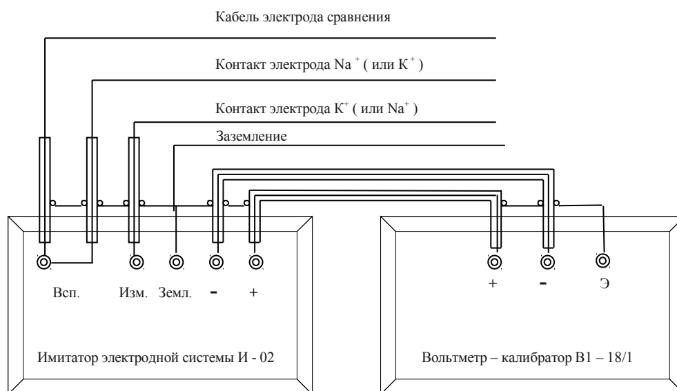
Рисунок 13- Схема установки для определения абсолютной погрешности измерительного преобразователя прибора
