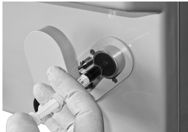
Рисунок 18 – Отбор пробы из шприца
