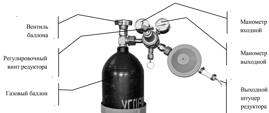
Рисунок 6 – Газовый баллон с редуктором
