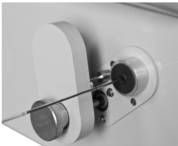
Рисунок 17 – Отбор пробы из стеклянного капилляра
