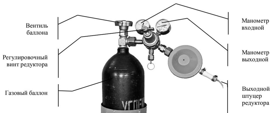
Рисунок 6 – Газовый баллон с редуктором
